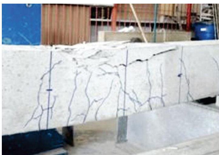
Figura 2.32 – Estado da viga com concreto de cimento Portland após o experimento, Pelisser et al. (2018)
