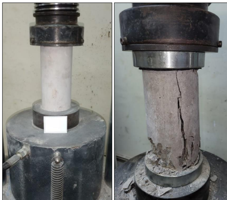
Figura 3.13 – Ensaio de compressão axial
