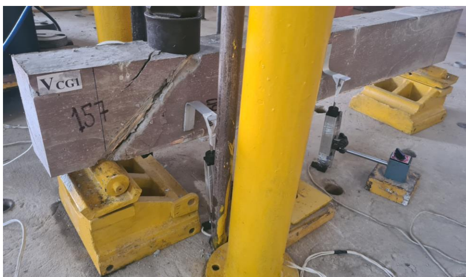
Figura 4.12 – Estado da viga V_{cc1} após o experimento
