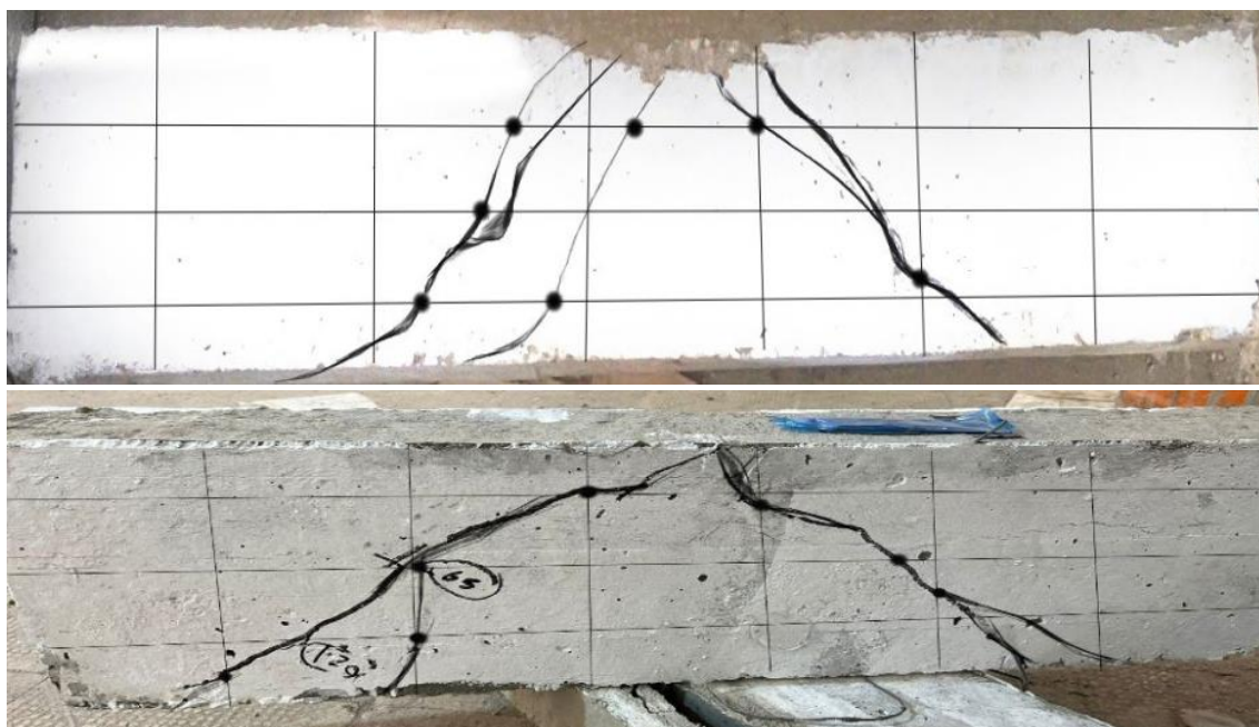
Figura 2.35 – Modo de ruptura das vigas de concreto convencional, Eisa et al. (2022)
