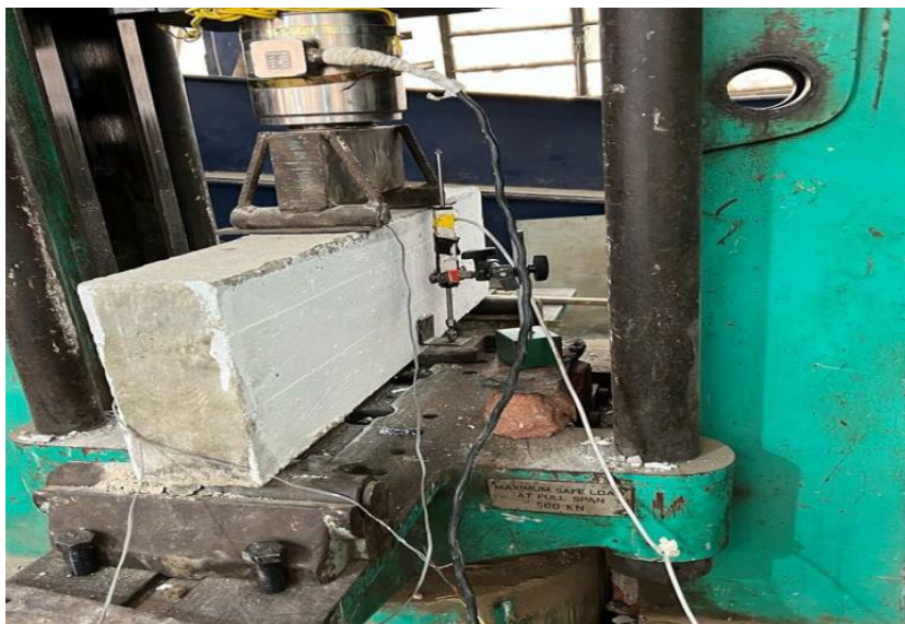
Figura 2.34 – Configuração do ensaio da viga, Eisa et al. (2022).
