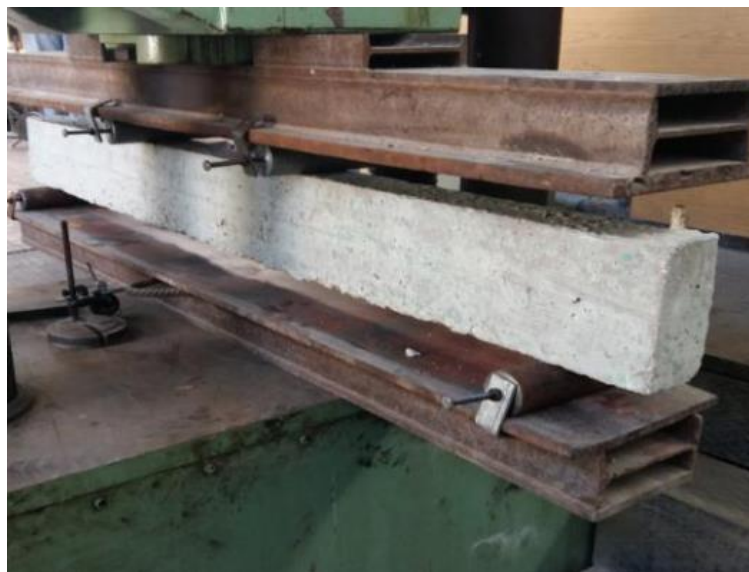
Figura 2.15 – Configuração do ensaio com carga aplicada em dois pontos, Ahmed & Lotfy (2017)
