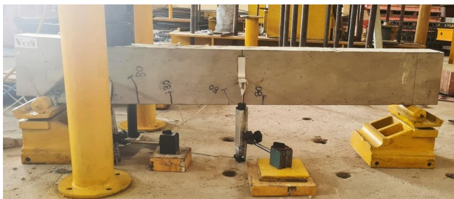
Figura 4.15 – Mapa de fissuração V cc1
