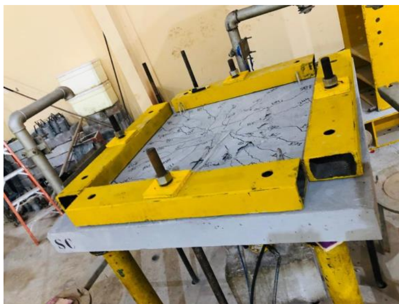
Figura 2.38 – Estado da laje após o ensaio (Azevedo, 2023)
