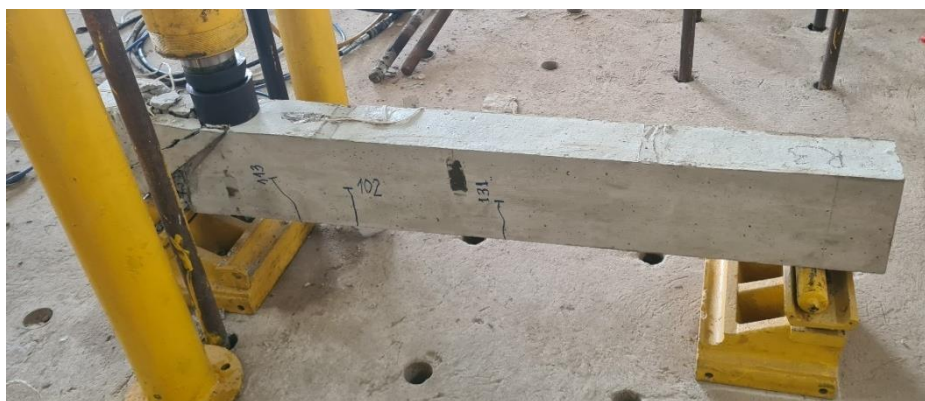
Figura 4.17 – Mapa de fissuração V cc2
