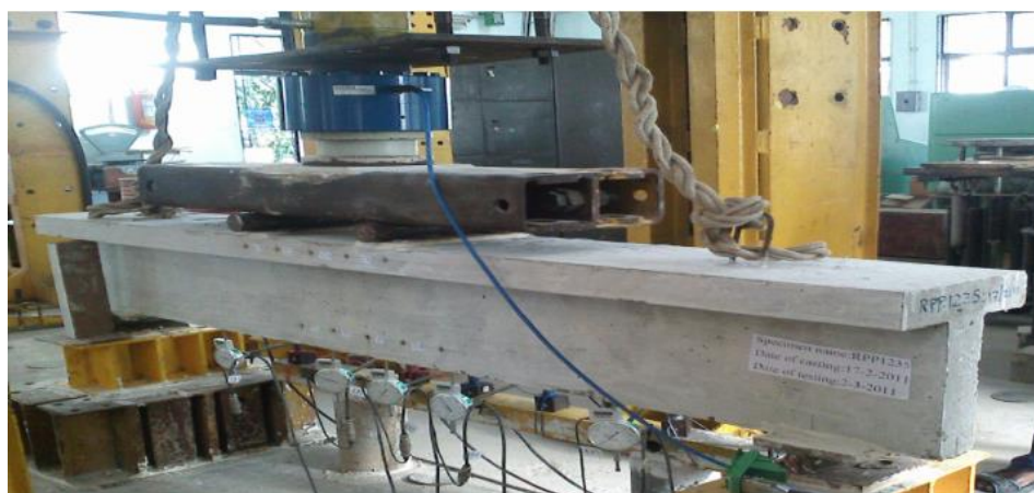
Figura 2.21 – Configuração do ensaio com carga aplicada em dois pontos, Ambily et al. (2012)
