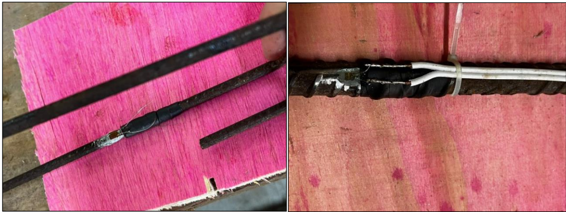
Figura 3.18 – Extensômetros nas armaduras transversal e longitudinal
