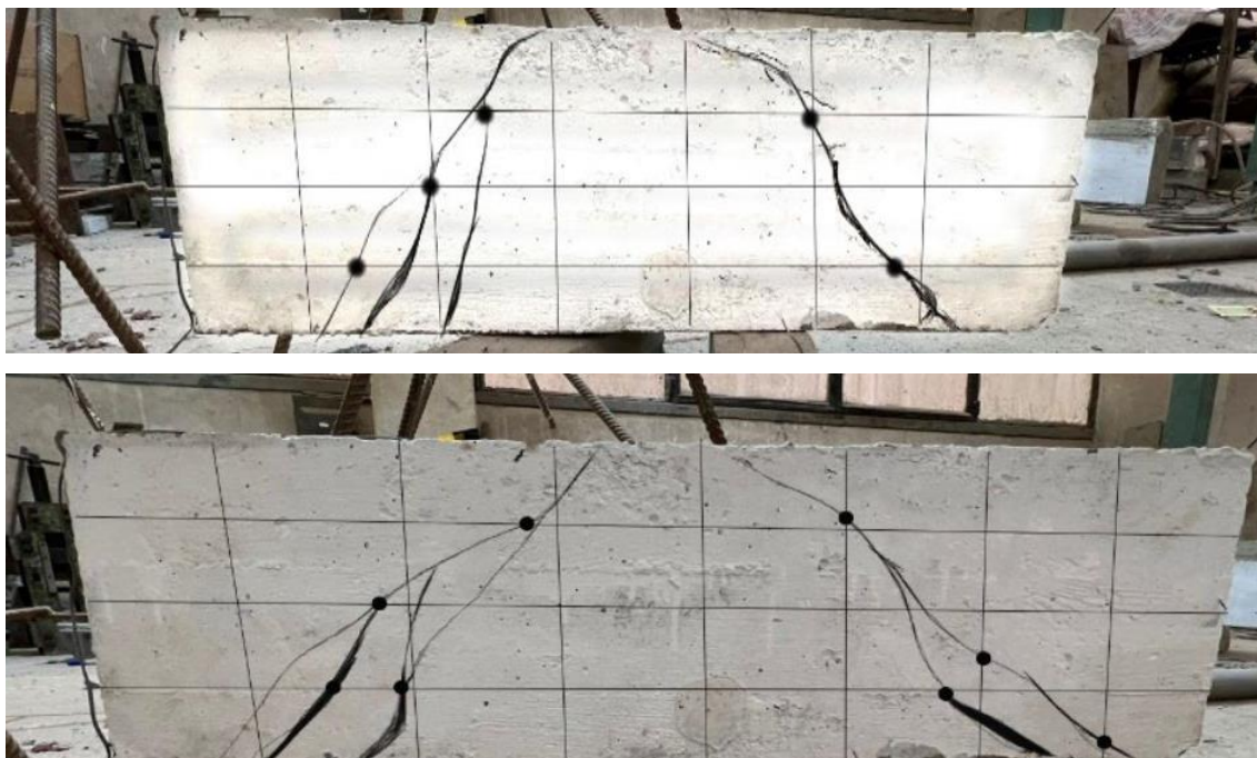
Figura 2.36 – Modo de ruptura das vigas de concreto geopolimérico, Eisa et al. (2022)
