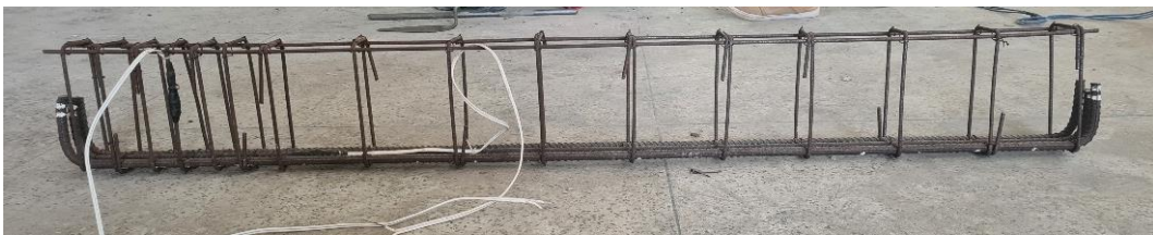
Figura 3.8 – Armadura da Viga VCG2
