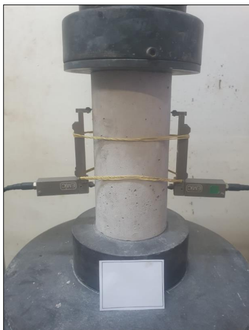
Figura 3.15 – Ensaio de módulo de elasticidade
