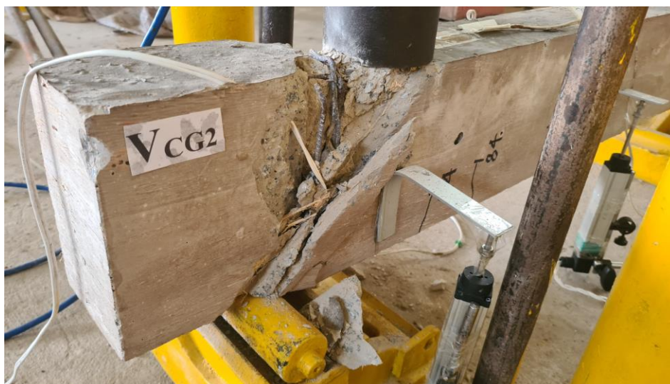
Figura 4.14 – Estado da viga V_{CG2} após o experimento
