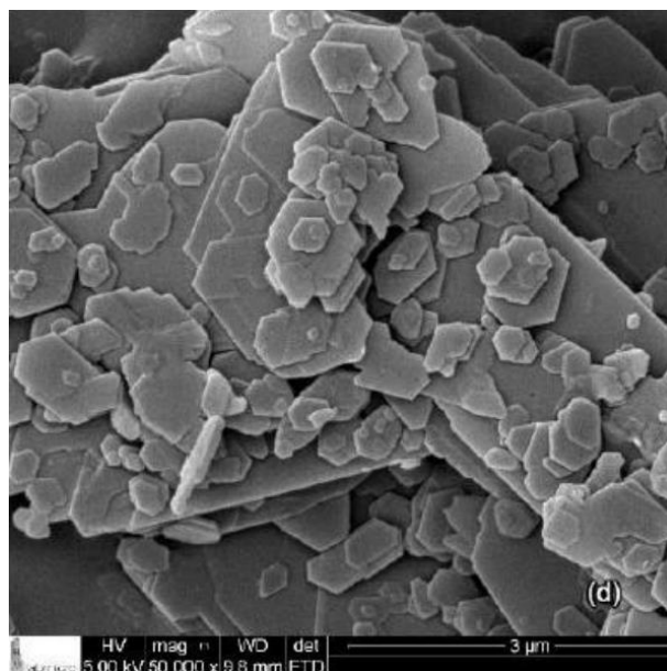
Figura 2.3 – Microestrutura do metacaulim, Andrades et al. (2020).
