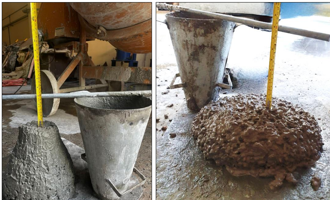
Figura 3.16 – Abatimento de tronco de cone
