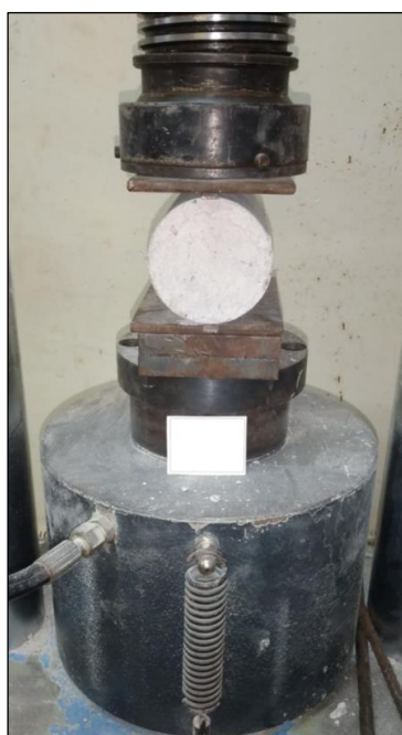
Figura 3.14 – Ensaio de compressão diametral
