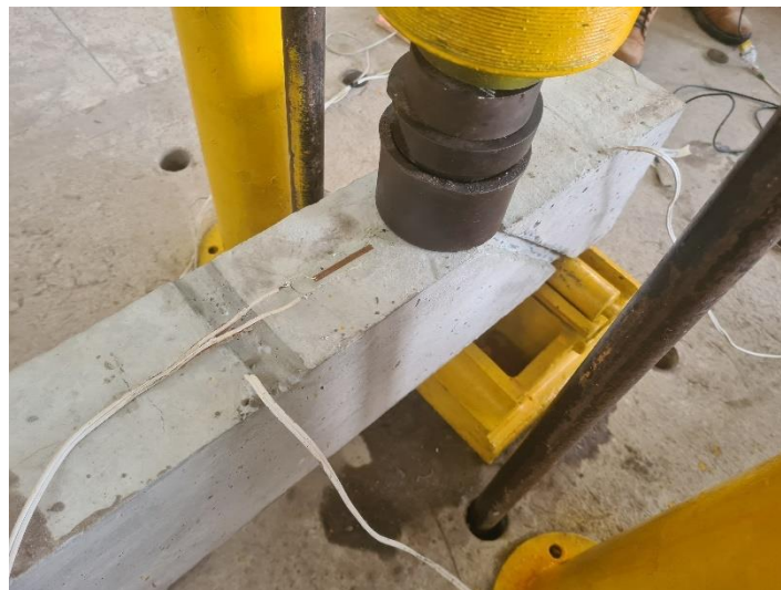
Figura 3.19 – Extensômetro no concreto
