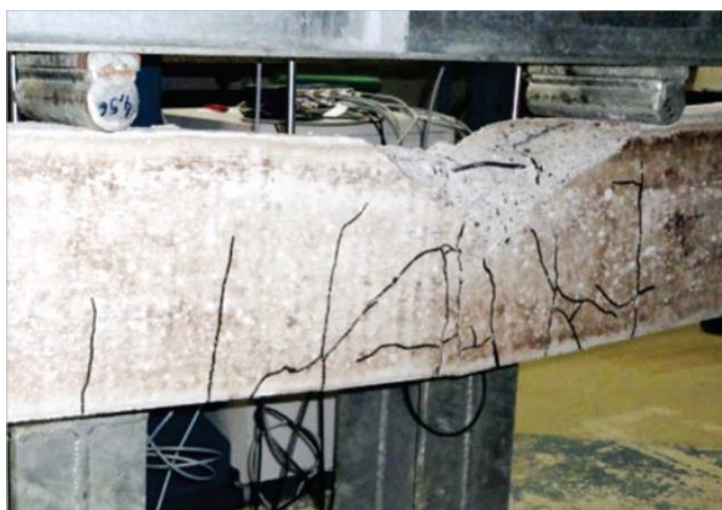
Figura 2.31 – Estado da viga com concreto geopolimérico após o experimento, Pelisser et al. (2018)
