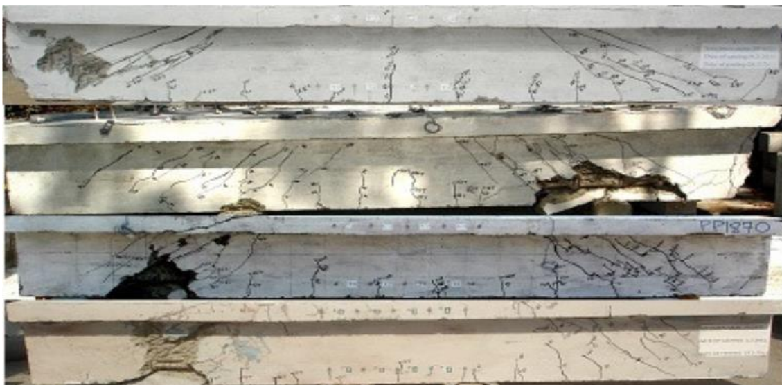
Figura 2.22 – Padrões de fissuras e modos de falha, Ambily et al. (2012)
