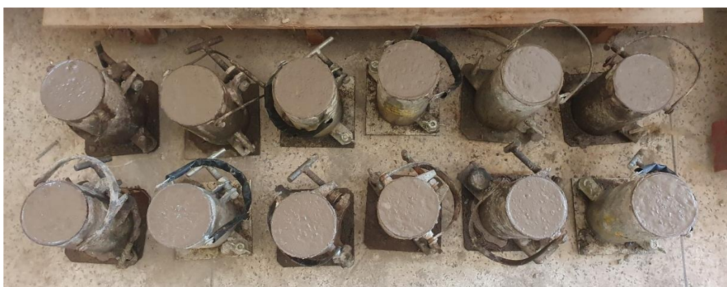
Figura 3.12 – Corpos de prova moldados
