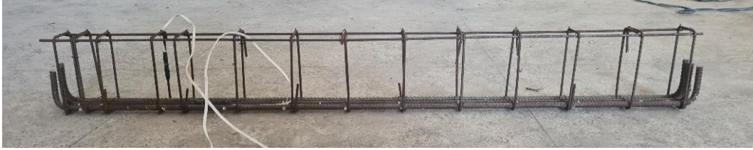
Figura 3.6 – Armadura da Viga VCG1
