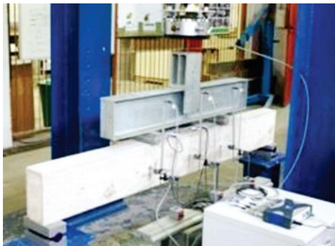
Figura 2.30 – Configuração do ensaio com carga aplicada em dois pontos, Pelisser et al. (2018)
