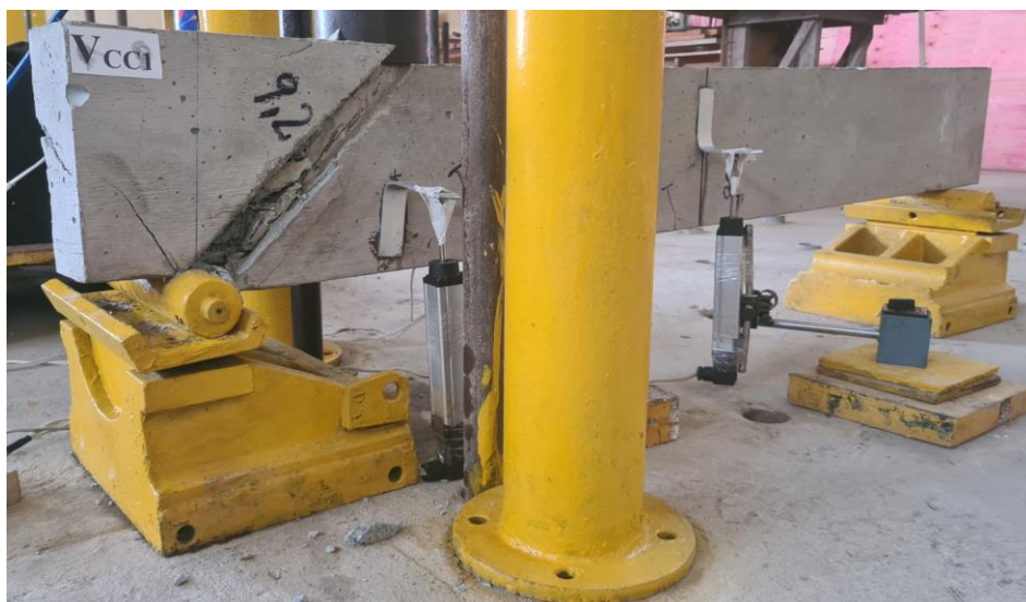
Figura 4.11 – Estado da viga V_{cc1} após o experimento
